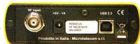
Na zadním panelu přijímače Perseus jsou konektory pro anténu, napájení a USB
