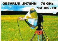
Obr. 7. Transvertor umístěn přímo do ohniska paraboly OE5VRL. QSL-listek za první spojení OE - OK na 76 GHz v závodě BBT 24. 5. 2008 s OK1AIY
