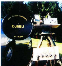
Obr. 8. Umístění transvertoru v ohnisku „ofsetky“ - DJ6BU
