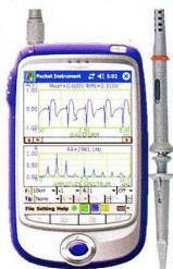
Jednotlivé měřicí přístroje lze používat i současně – zde osciloskop a spektrální analyzátor
